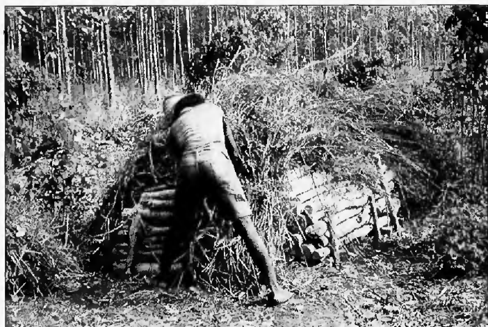
Préparation d'une meule de charbon de bois au Togo. Photo : P. GIRARD.
