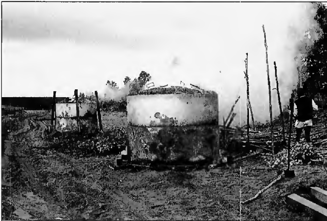
Chantier mobile de carbonisation en bordure de plantations à Pointe-Noire. Photo : P. GIRARD.
