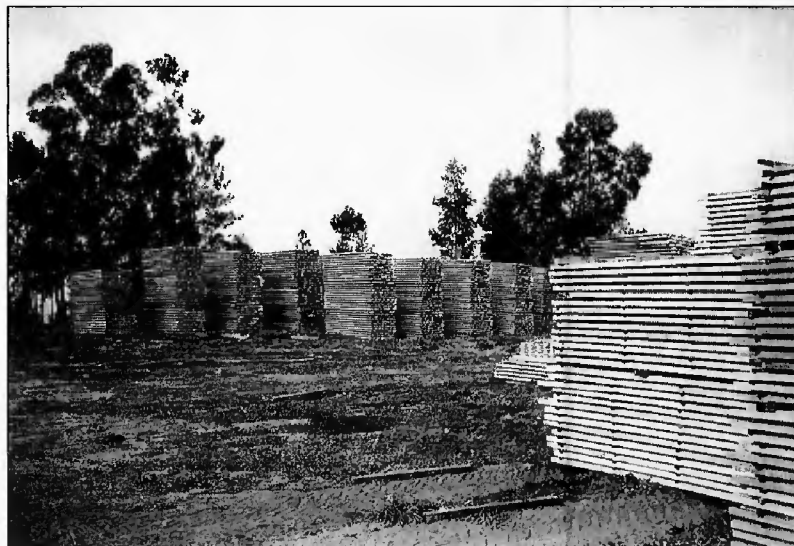
Séchage à l'air de carrelets d'eucalyptus pour la fabrication de parquets (Portugal). Photo : J. GÉRARD.
