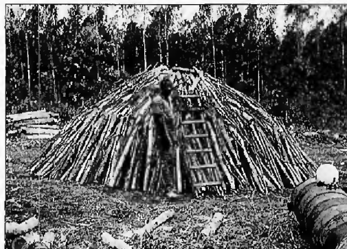
Préparation d'une meule casamançaise dans les plantations du projet AFRI (Togo), on notera l'importance de l'implantation au sol. Photo : P. GIRARD.
