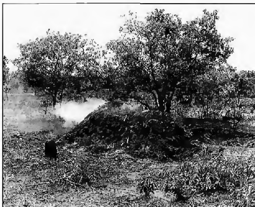
Meule traditionnelle horizontale en cours de combustion. Photo : F. BESSE.
